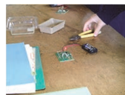
(写真3) ニッパーで断線させ発光ダイオードの点灯により回路確認
